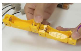
將電池座以串聯方式連結
