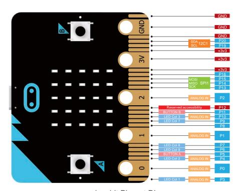
micro:bit Pin-out Diagram
